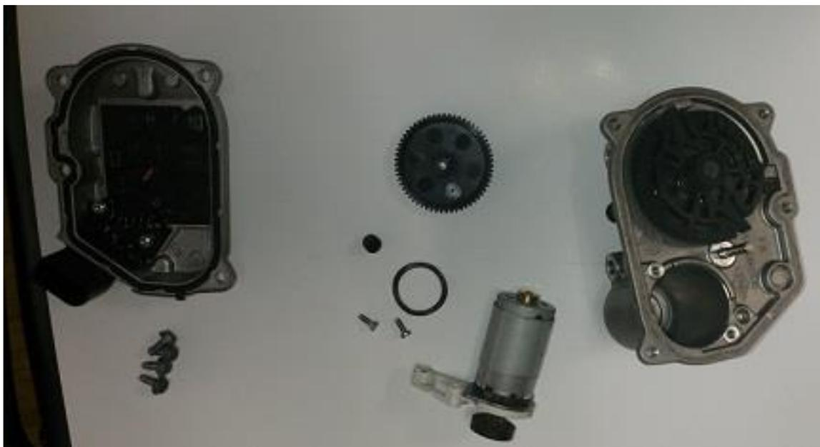
4 Шаг. Возьмите ту часть моторчика на которой осталось фишка. По данной схеме отсоедините лишние провода и в их место нужно припаять провода от эмулятора.
